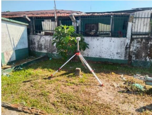
**Foto 23.** Mojón IBGE-92555 e instalación del receptor base. Fuente: OTCA & SHI SAS (2023).
